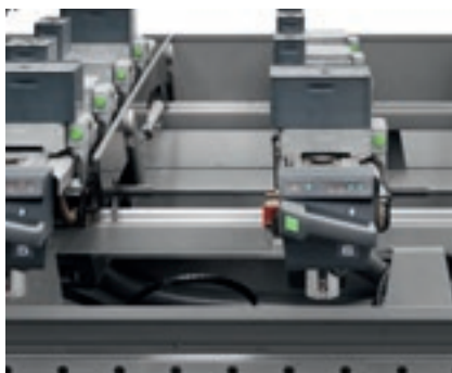
SA (辅助设置) 设定辅助工作台建议操作员如何定位板件 (指示工作台和吸盘的位置), 并且保护工作区域避免发生刀具碰撞。
